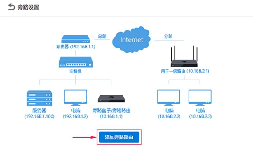
旁路可通过 IP 网络段和 IP 地址两种进行设置
