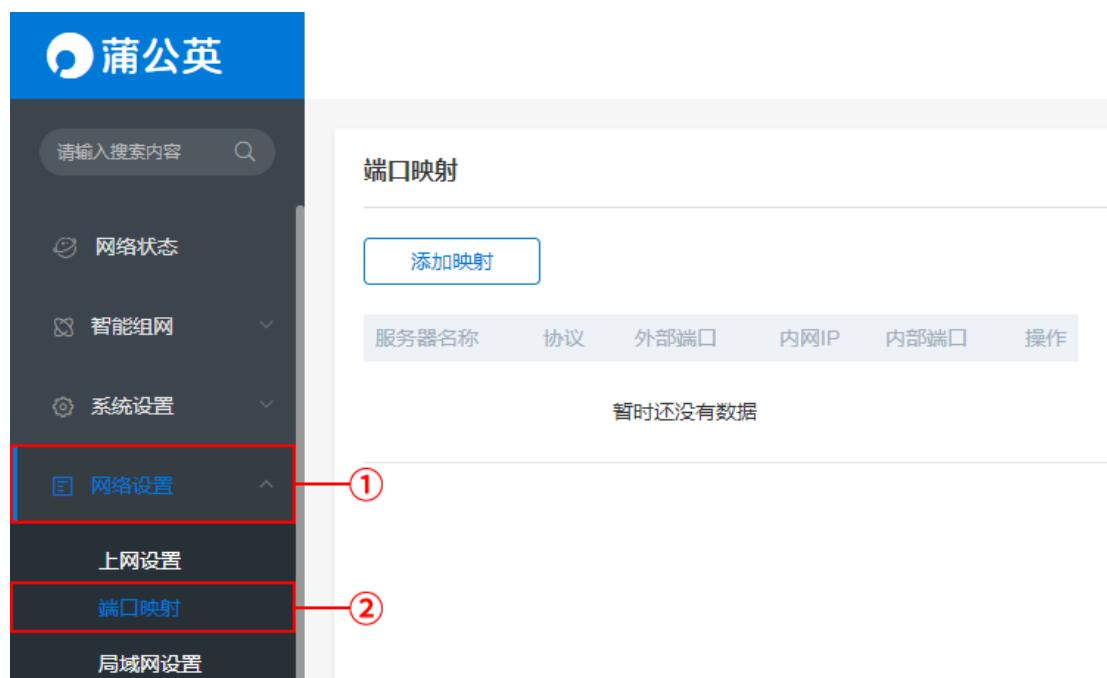
自定义虚拟服务器名称，填写内网服务器 IP 地址，内部端口号及外部端口号。
