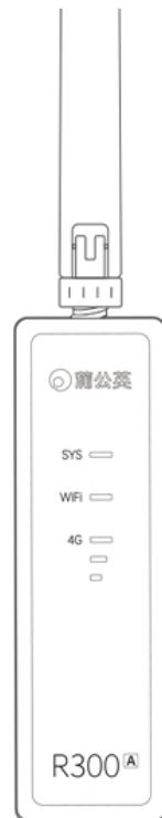
蒲公英 R300C 由于支持双 SIM 卡接入，前面板有四种类型的指示灯，分别为 SYS 系统指示灯、WIFI 信号指示灯、4G 信号指示灯及 SIM 卡指示灯。
