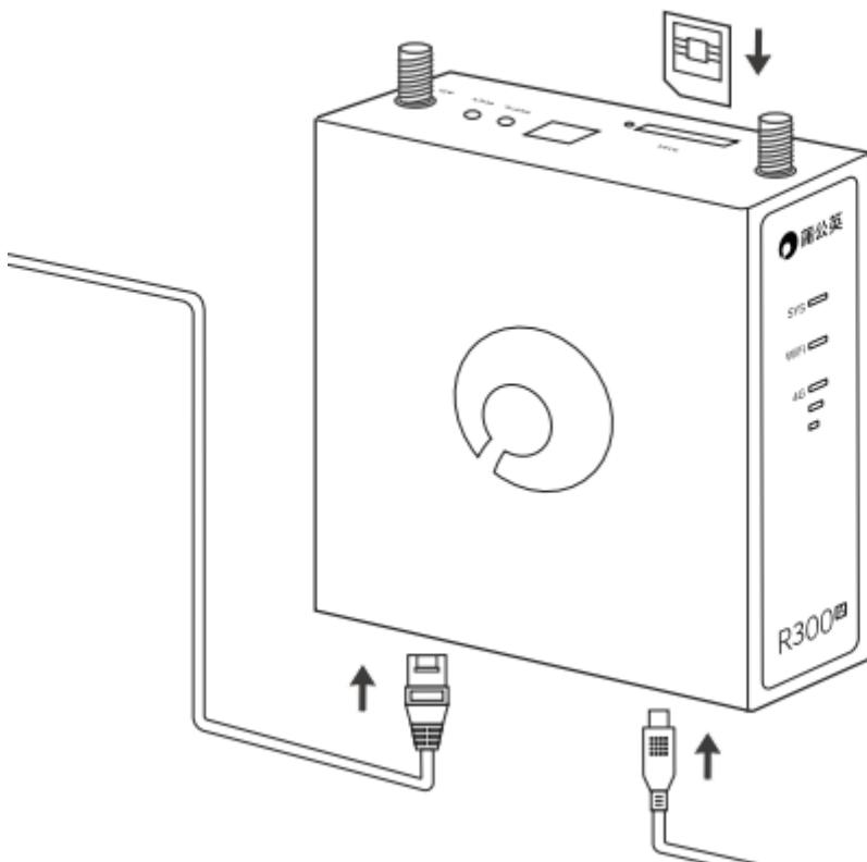
(1) 连接佩带的电源适配器
